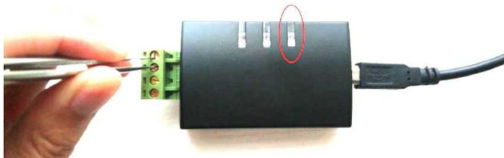
Wird der Kurzschluss aufgehoben, erholt sich der Mbus automatisch und die USB-Anzeige leuchtet wieder.
