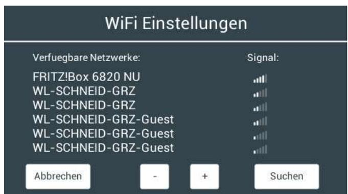
Wurde das Passwort korrekt eingegeben und die Verbindung zum WLAN-Netzwerk erfolgreich hergestellt, so wird nun statt den verfügbaren Netzwerken die IP-Adresse des FBR angezeigt.
