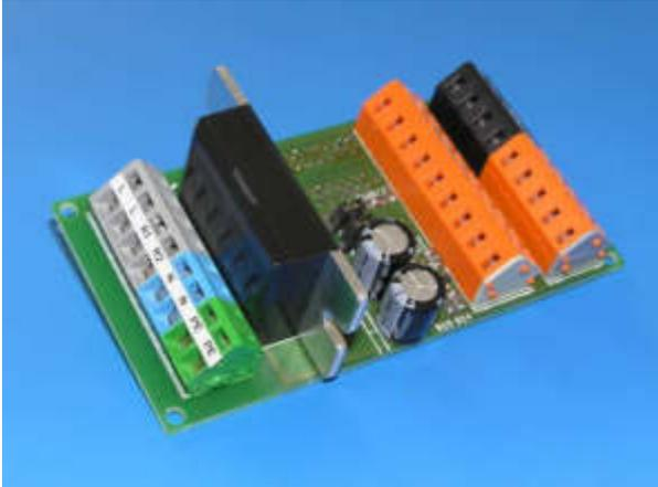
Abbildung 3: Drehzahlregel-Modul mit einem Ausgang
