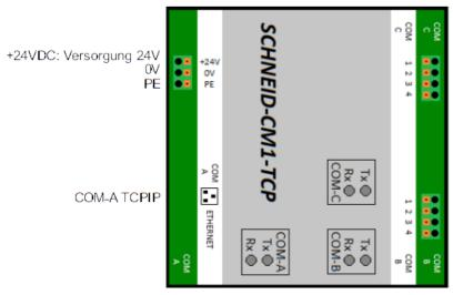
Klemme 1: COM-C D+ Klemme 2: COM-C D-Klemme 3: COM-C D+ Klemme 4: COM-C D-
